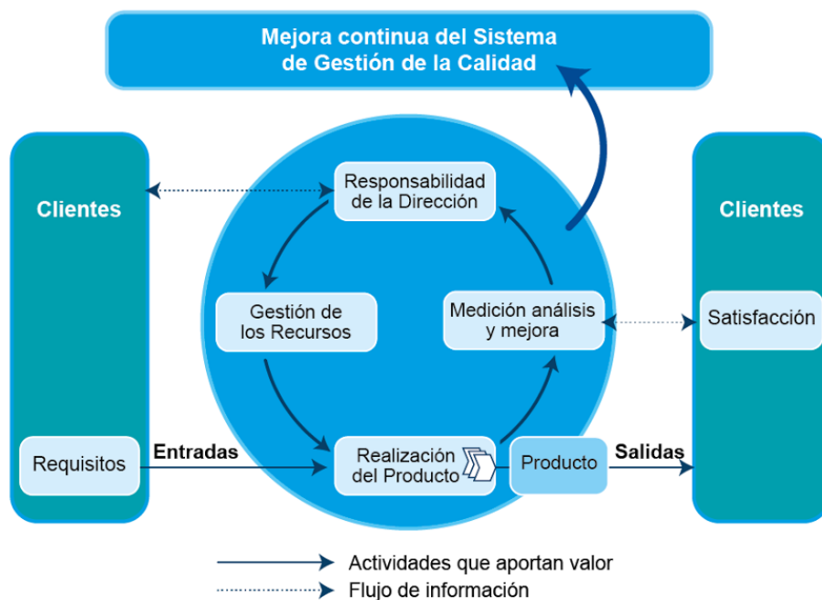
Ilustración No. 1 Modelo de un sistema de gestión basado en procesos.
